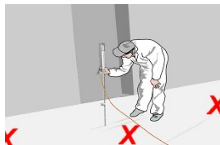
Vérification de l'épaisseur par jauge à niveau d'eau
